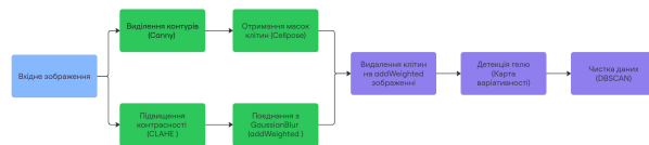
Рис. 6. Блок-схема повної обробки зображення для детекції гелевих структур
